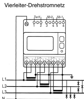
Die Schraubklemmen können nach dem Anschluss mit einer plombierbaren Klemmenabdeckung gegen Manipulation geschützt werden.
