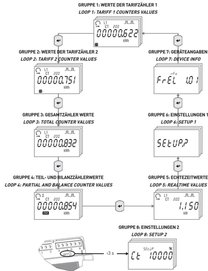
**ANMERKUNG:** bei einer 3-Leiter Ausführung werden die Anzeigeseiten der Phasenwerte abwesend sein. *NOTE: in case of 3 wires model, pages showing phase values are not available.*
