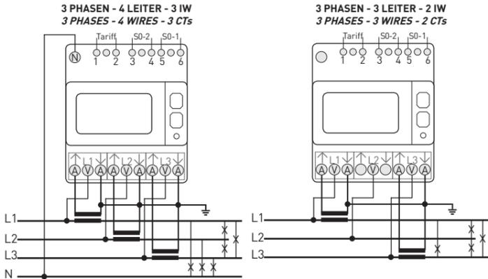
Der Zähler funktioniert einwandfrei auch nur mit einer angeschlossenen Phase. Mit diesem Anschluss wird die Hintergrundbeleuchtung zum Energiesparen ausgeschaltet.
