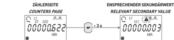
Auf der Seite mit dem Sekundärwert wird das Stromwandlerverhältnis durch **SEC** ersetzt. *On the secondary value page, SEC is displayed instead of CT ratio value.*
